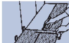
Kapping av avslutningsbrettet.
